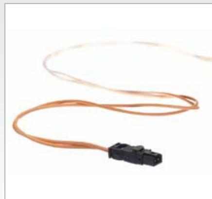
Кабель с витой парой проводов с двойной изоляцией, один конец которого подключается к ЦИП, а другой замыкается накоротко на соединитель со смещением изоляции (IDC); таким образом обеспечивается возможность подключения нескольких светодиодных светильников с различными значениями управляющего тока. Оранжевый кабель имеет двойную изоляцию, оболочку LSON (с малым выделением дыма, без выделения галогенов) и поставляется с установленным разъемом для быстрого подключения к ЦИП.
