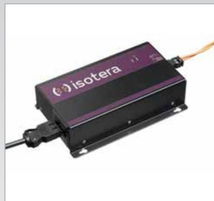
Сверхэффективный силовой преобразователь системы, который преобразует переменный ток сети питания напряжением 230 В в постоянный ток низкого напряжения высокой частоты, который затем подается на шину из пары оранжевых скрученных проводов.
